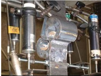
JES継手単体引張試験
