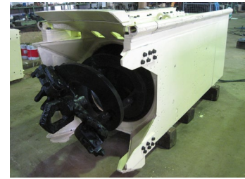
掘削装置(オーガータイプ)
